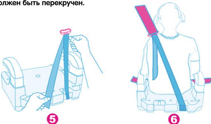
5. Бустер всегда должен быть закреплен ремнем безопасности, даже если он не используется. Не закреплённый бустер может нанести травмы другим пассажирам в машине во время резкого торможения (рис.7).
